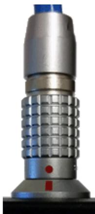
**Рисунок 1:** Разъем Lemo к устройству GK-404
